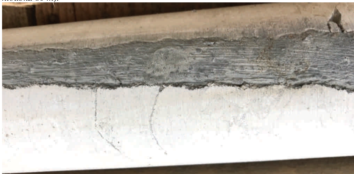
Obrázek č. 7.3: Detail strmě skloněné trhliny rozevřené cca 2 cm, vyplněné pevným jílem (vrt S104, hloubka 80 m).
