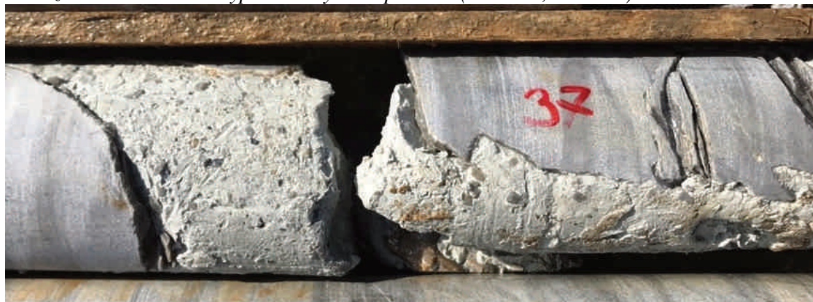
Obrázek č. 7.1: Jílovitá výplň trhliny ve vápencích (vrt S105, hl. 37 m).
